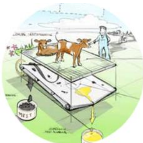
Figuur 7: V-vormige mestband voor gescheiden afvoer van mest en urine (Ellen, Jansen, Smit & Vermeij, 2014-a).
